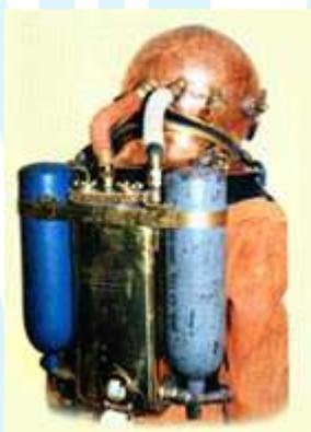
En 1938 apparaît le DM40 de la société Draeger. C'est un recycleur (rebreather) que les plongeurs portent dans le dos. Il est basé sur les mêmes principes que l'actuel Dolphin ou Ray de cette compagnie. Dans le dos, on trouve une bouteille d'oxygène pur et une d'air comprimé pour faire un mélange calculé d'un bon NITROX ! Deux tuyaux à l'arrière du casque permettent de former un circuit d'air neuf et d'air à régénérer.
